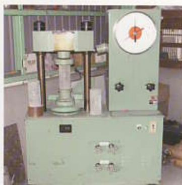
コンクリート圧縮強度試験状況
